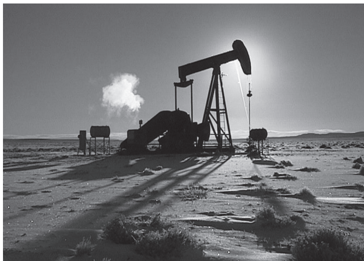
Bomba de varilla (más conocida como “guano” o “cigüeña”) para la extracción de petróleo en medio de la nieve, en Neuquén.
